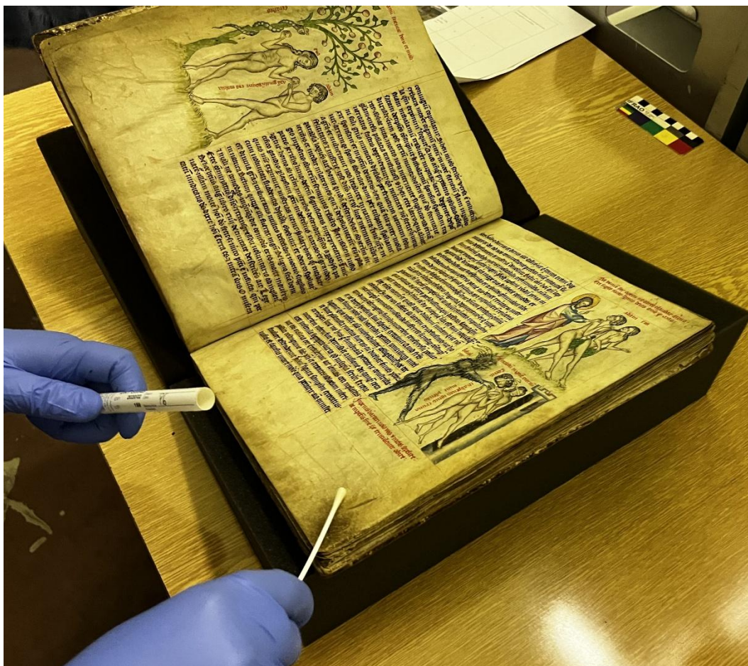
Obr. 3: Odběr vzorku z povrchu knihy sterilním stěrovým tamponem za účelem mikrobiologického vyšetření
