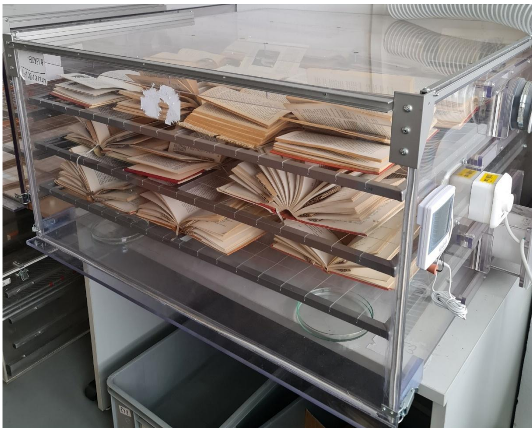
Obr. 6: Hermeticky uzavřený dezinfekční box pro ošetření knih parami butanolu
