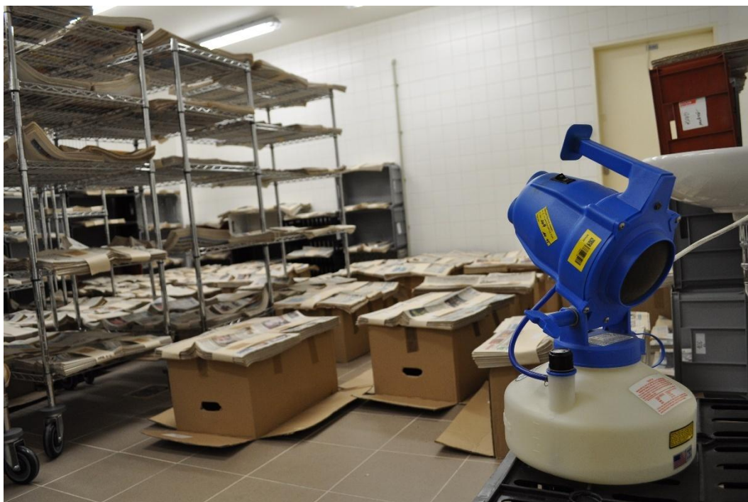
Obr. 7: Dezinfekce zmlžováním („fogging“) v zmlžovací komoře
