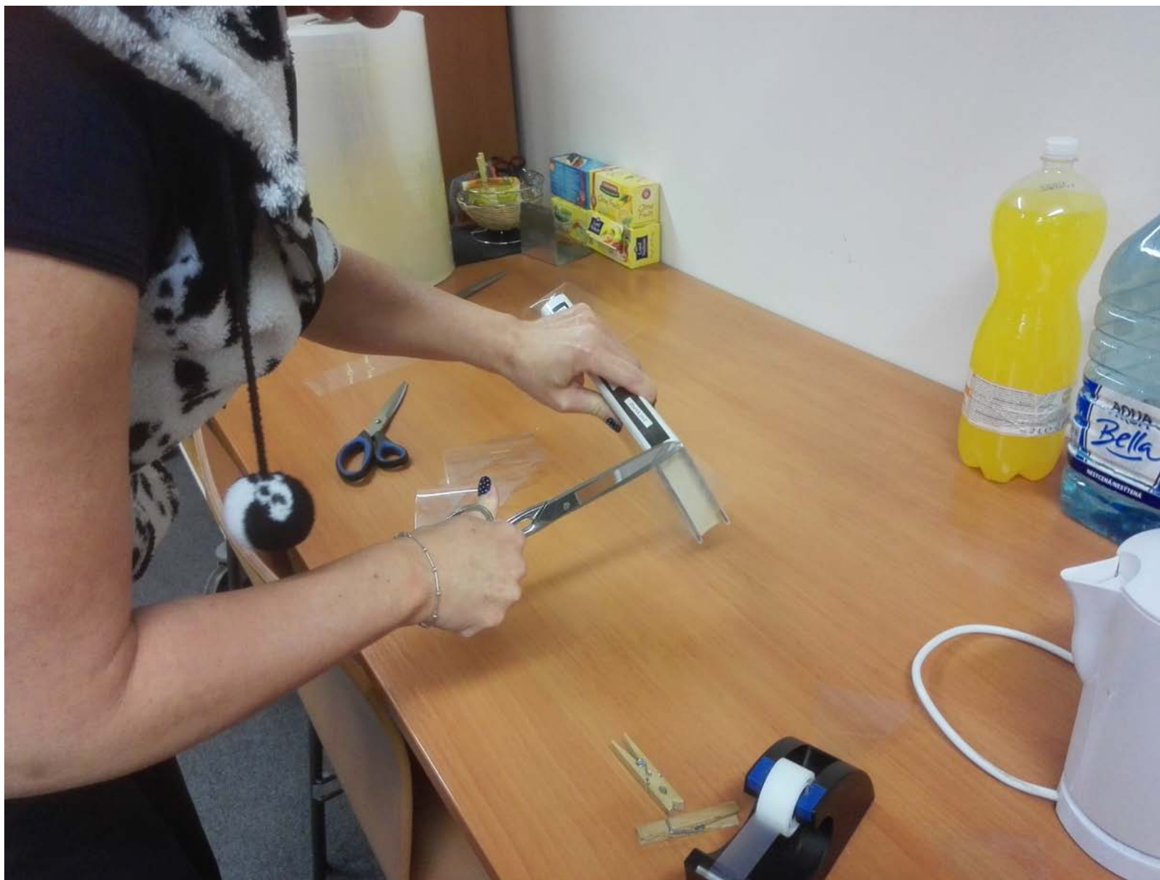
Obr. 15 Zastříhneme-založíme fólii u hřbetu směrem dovnitř
