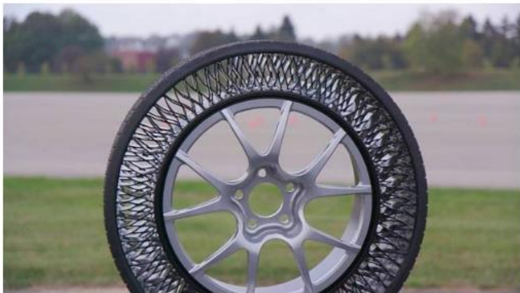
Pneumatiky Goodyear Airless | Foto: ČTK
